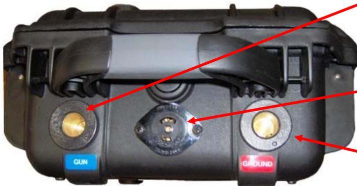
Stud Gun Weld Cable Connection
